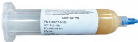
Флюс-гель выполняет три основные функции. Первая – эффективная передача тепловой энергии при пайке для быстрого и равномерного прогрева выводов. Вторая – удаление оксидной пленки и обеспечение хорошей смачиваемости на бессвинцовых покрытиях.
